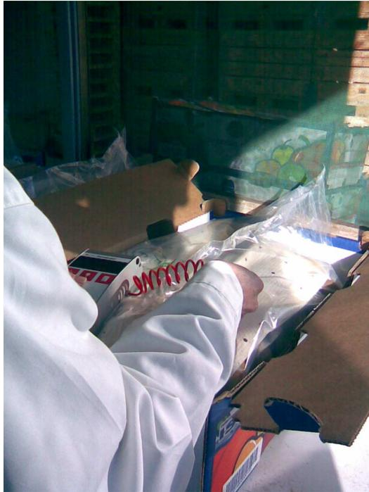
Fotografía. N°9: Obtención de niveles de  $\text{O}_2$  y  $\text{CO}_2$
