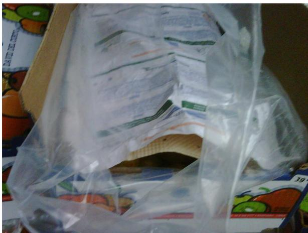
Fotografía. N°3: Disposición del papel absorbente y papel KEEP FRESH en la muestra tipo C
